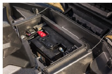
STORT, KRAFTFULLT 18AH AGM BATTERI
