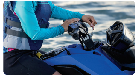
Styre med justerbar styrehöjare Ett teleskopiskt styrsystem som optimerar upplevelsen för förare med olika längd.
